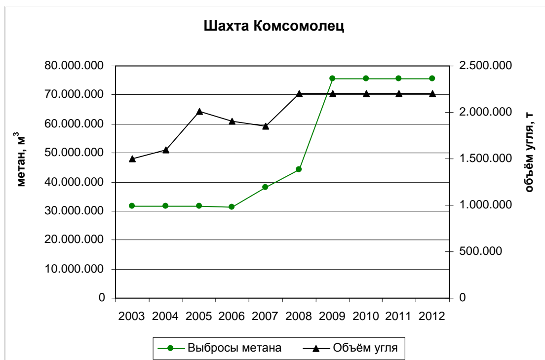
Рис. Приложение 2-5: Соотношение добычи угля и метана на шахте Комсомолец. В 2009 одна из зон ведения горных работ переместилась на более глубокий угольный пласт с более высоким содержанием метана.
