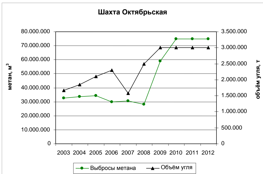
Рис. Приложение 2-4: Соотношение добычи угля и метана на шахте Октябрьская. В 2009 одна из зон ведения горных работ переместилась на более глубокий угольный пласт с более высоким содержанием метана.
